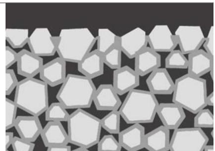
Die Oberfläche zeigt sich glatt, mit kaum losen Körnern. Das Bindemittel wird auf der obersten, befahrenen oder begangenen Schicht im Lauf der Zeit abgenutzt, das heisst, die gewählte Kiesart wird wieder sichtbar.
